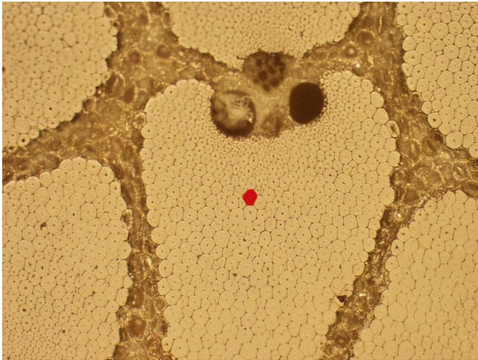
図3 中国産トンキンのファイバー束の断面図。赤色で示された単繊維は0.03mm
