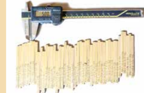
Handhyvlade Tonkinprover för trepunkts böjningstest, 3 mm tjocka, 5 mm breda, 80 mm långa. Före böjning mäts varje provs dimension och vikt individuellt.
